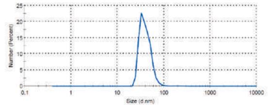
Aquí hay un análisis típico de liposomales de keMvida por el método de **Dispersión de luz dinámica (DLS)**, técnica utilizada para medir la distribución de tamaños de partícula.
